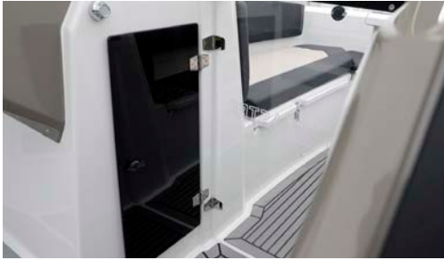
Låsbara förvaringsutrymmen under SB & BB konsol.
